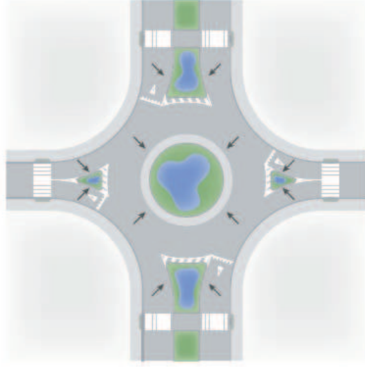
c. Integralna pristup 2: Sve oborinske vode su usmjerene na središnji sustav rotora s uređenim bioretencijama
