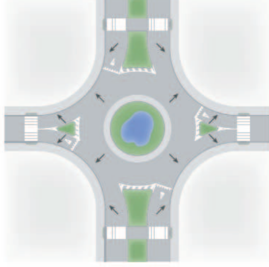
d. Integralna pristup 3: Sve oborinske vode se usmjeravaju prema središnjem sustavu bioretencije i zelenih poteza te se drenažnom mrežom odvođi izvan tijela ceste u prirodni krajobraz
