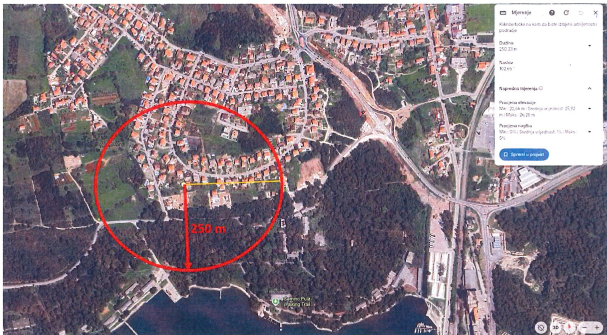
Slika 1. Sigurnosna zona od zračnog udarnog vala
