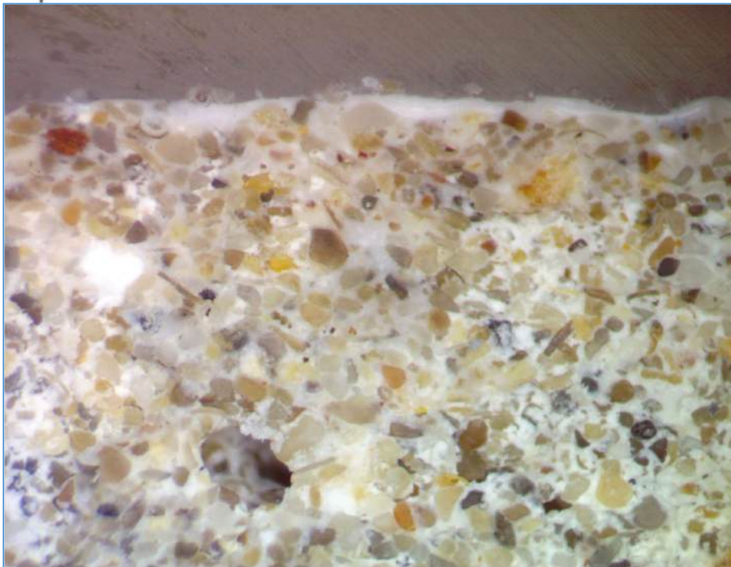
Slike 1 i 2. Fotografije mikropresjeka ŽBUKA 1, pri uvećanju P=10× i P=20×.
